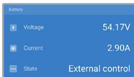
Die VictronConnect-App zeigt an, dass das Ladegerät von einem externen Gerät aus gesteuert wird.
